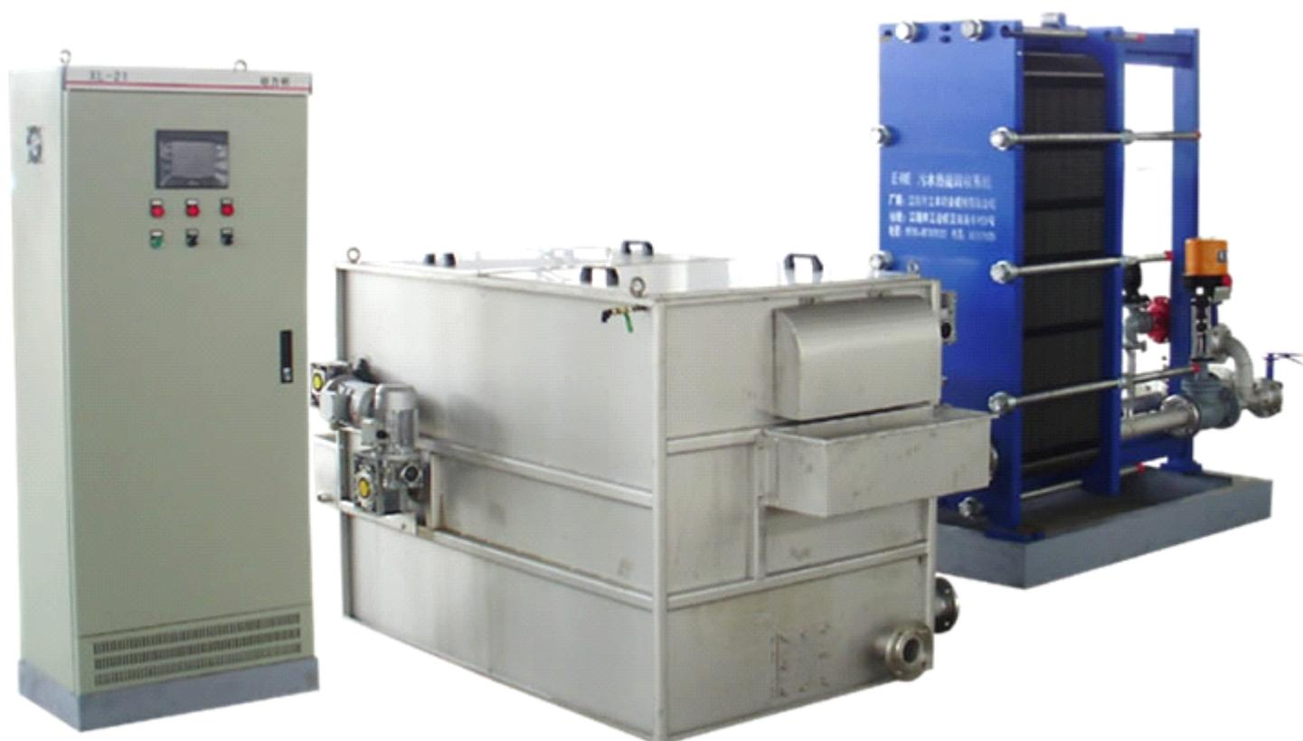
该产品适用于梭织布、针织布、纱线等印染厂前处理及染色后废水的余热回收。洗染设备中的热水用于洗染后就成了废水，但废水还有较高的温度，为了充分利用废水的热能，通过高效热交换器吸收废水中热能进行废水余热热能回收，转换到洁净水中，由冷水变为暖水，用这些暖水输入到热水池中，用作染整中的洗涤用水。降温后的废水通过排水管排出。余热回收技术主要是研制高效热交换器及过滤辅助设备。江阴市立丰印染机械有限公司经过几年的努力，成功开发出 E. RE 系列污水的热能回收系统、刁系列自洁式热能回收系统。以上系统均以个性化的工作流程，对不同类型的污水，采用不同的回收装置结构，以方便热交换器中的污水剩积杂质的清除，其最高热能余热回收效率可达 80%-90%。
